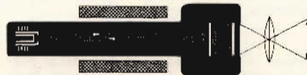
Fig. 1 - Rappresentazione schematica di un tubo da ripresa TV, del tipo image orthicon.
