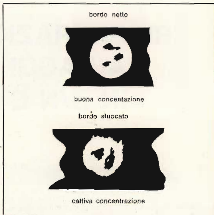
Fig. 3 - Punto luminoso di «Spot» che rispecchia macchie di isolamento.
